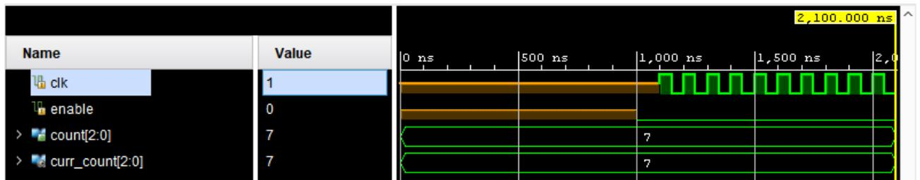
Damit der Zähler auch wirklich zählt, müssen Sie jetzt noch das «enable» Signal auf «1» setzen, und die Simulation weitere z.B. 1000 ns laufen lassen. Dann sollten Sie den Zähler zählen sehen ...
